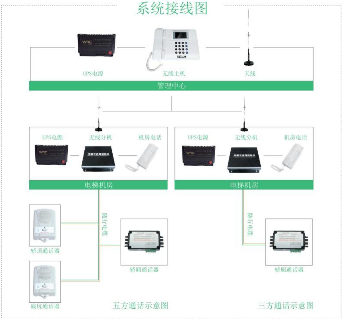
接线说明：对讲系统分机同时兼容两线制和四线制分机，两线制分机插头为三根线，分别按颜色与我司配置机房话机、轿厢通话器等设备相连，四线制分机插头为四根线，分别为红接 12V+，黑接 GND，绿接 R(Y)，黄接 L (K)。
